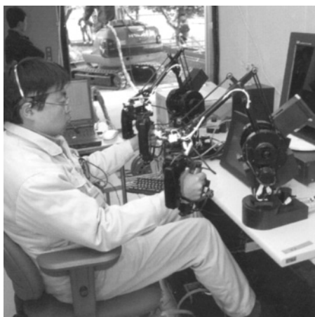
Вверху: робот HRP-2 (Япония) управляет экскаватором. Внизу: человек руководит действиями робота HRP-2
